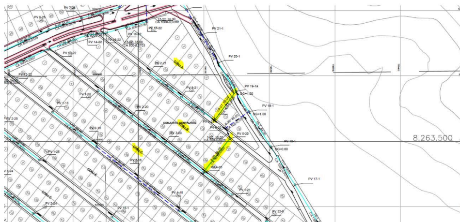
Figura 3 – Travessias da rede de drenagem Conjuntos A, B e C do Conjunto Centauros - 2004
